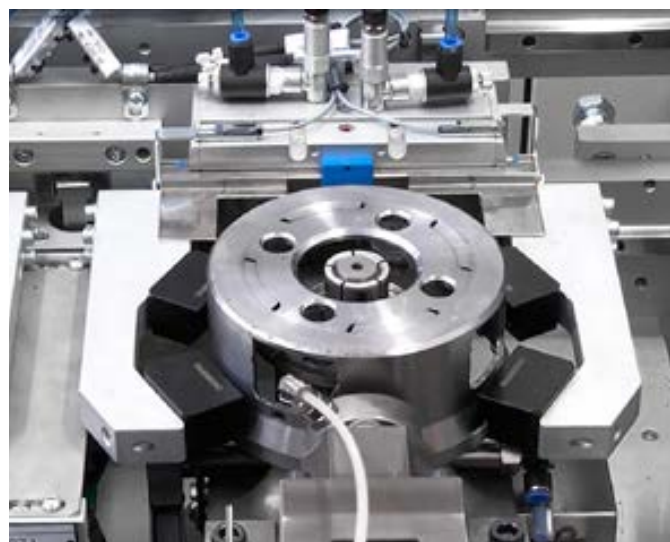
Impianto automatico per la correzione di componenti automobilistici (parti del cambio) con correzione automatica tramite punzonatura orizzontale completa di caricatore lineare e nastri trasportatori.
