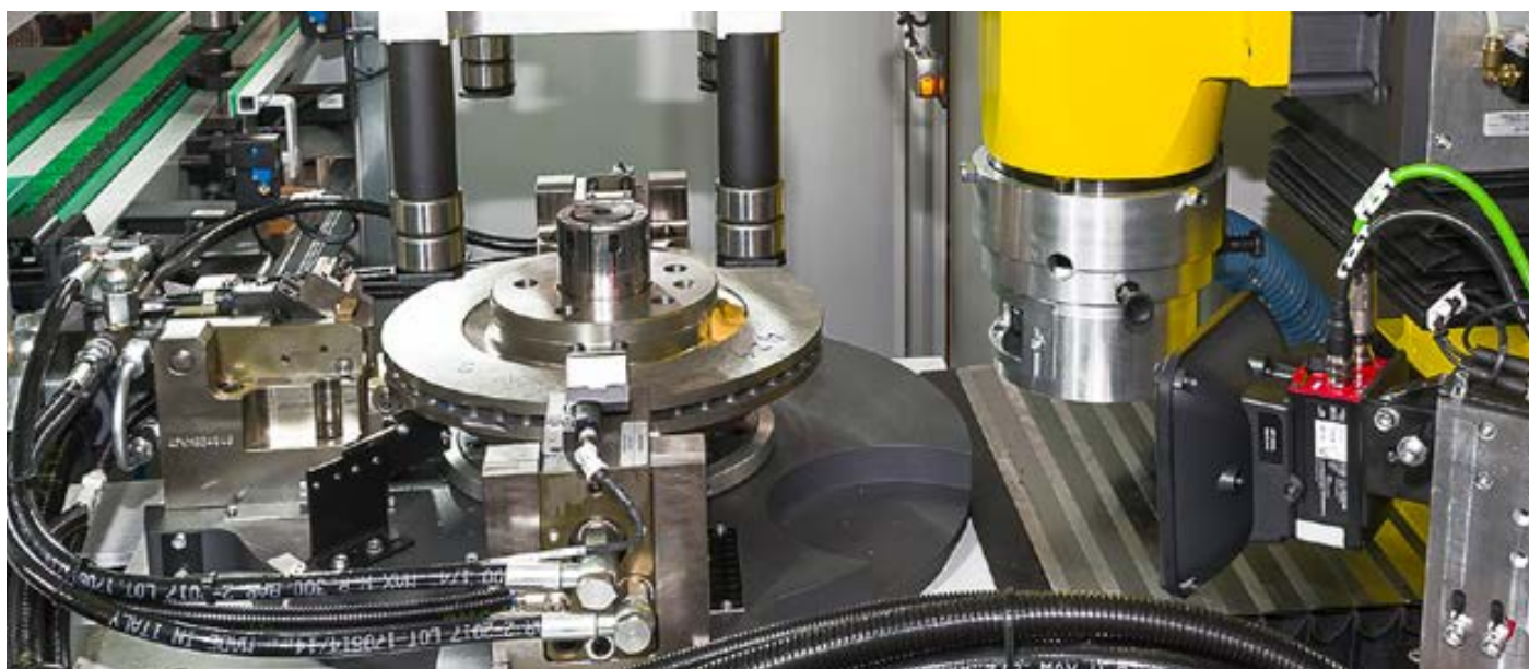
Impianto di equilibratura completo di lettore codice Datamatrix posizionato automaticamente tramite attuatore pneumatico. Balancing system equipped with Datamatrix reader automatically positioned by a pneumatic actuator.
