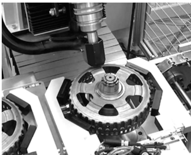
Impianto automatico per la correzione di componenti automobilistici (parti del cambio) con correzione automatica tramite foratura inclinata completa di caricatore lineare e nastri trasportatori.
